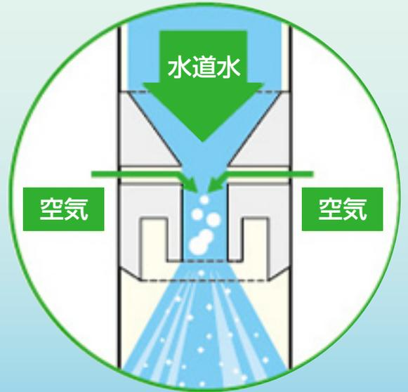
水の通り道が狭くなると水圧は上がります。この負圧を利用して水中に空気を取り込み、ミクロの泡に拡散させます。
